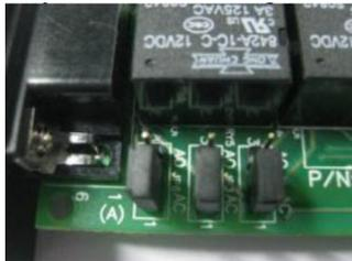
Abbildung 3: Jumperstellung Öffner (AO)
